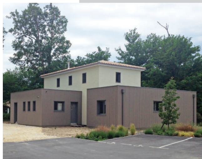
Funlam® épicea - Profil 21 - Peinture blanc perle C-s2, d0 et Openlam® épicea - Profil 73 - Peinture gris taupe C-s2, d0
