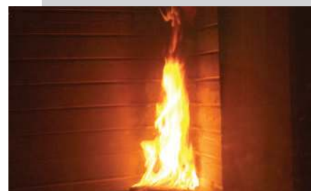
Essai feu bardage ignifugé
